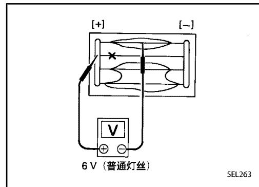
3. 如果加热丝熔断，电路测试仪提示 0 或蓄电池电压。
