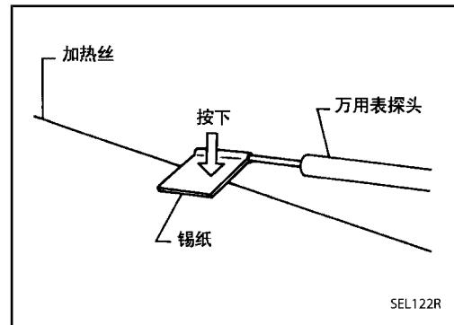
2. 把探针电路测试仪 (电压范围内) 附在每个加热丝的中部。
